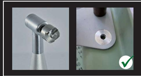
**AL-1 Akku-Entgrater mit Senkwerkzeug - 0-Fehler
